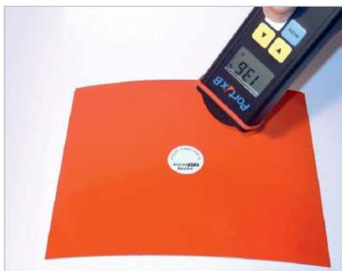
Obr. 2 Meranie teploty pomocou emisnej nálepky s definovanou emisivitou
