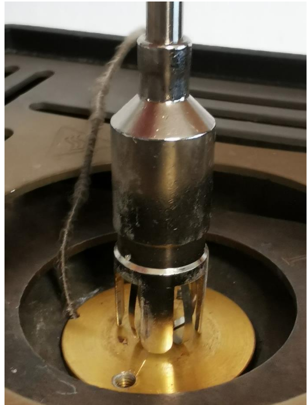
Obr. 1 - Meranie teploty povrchovým teplomerom
