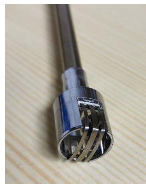
Obr. 3 - Povrchový teplomer s viditeľným meracím spojom
