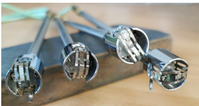
Obr. 4 - Poškodené povrchové teplomery
