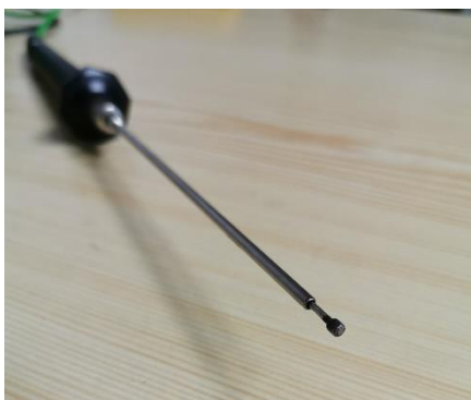
Obr. 2 - Povrchový teplomer so zaliatym meracím spojom
